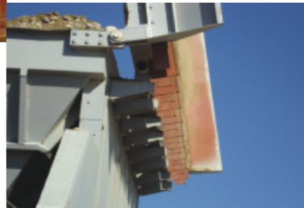
Grille de scalpage escamotable : un barreau sur deux libre pour permettre l'éjection des pierres restées bloquées
