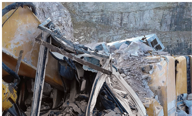
Effondrement d'un éperon rocheux sur une pelle
