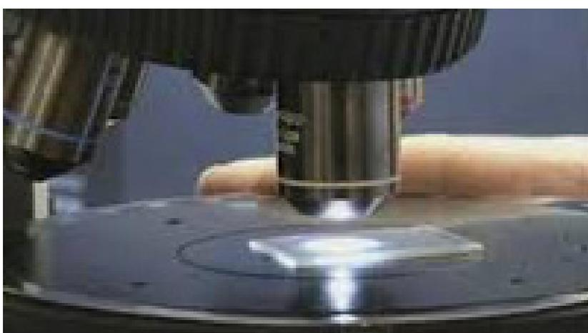
Lame mince observée au microscope optique polarisant
