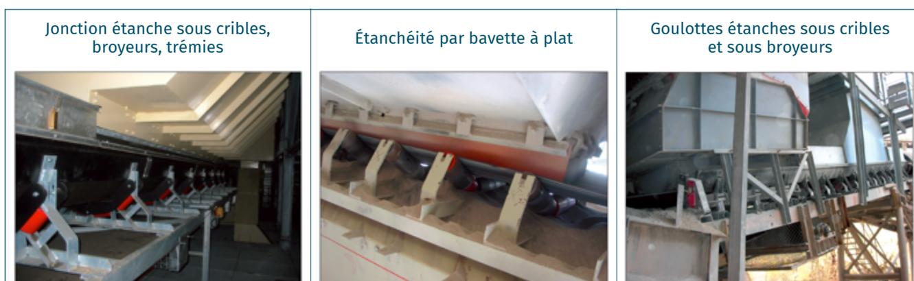
Rives segmentées, réalisées en éléments souples (caoutchouc, polyuréthane, etc.), elles permettent un réglage précis et une rapidité d'intervention « on ne change que le segment usé »
