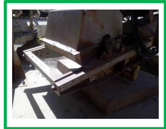
✓ Mettre en place un tambour bombé ou ajouter une épaisseur sur ce dernier afin de réduire le déport de bande.
